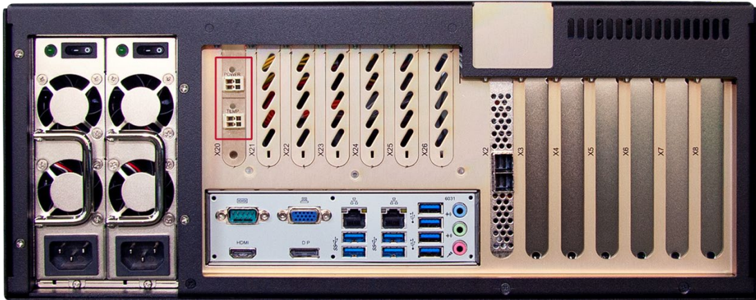
Eingebaute ibaOut-Temp-Karte am Beispiel vom ibaRackline-PC
