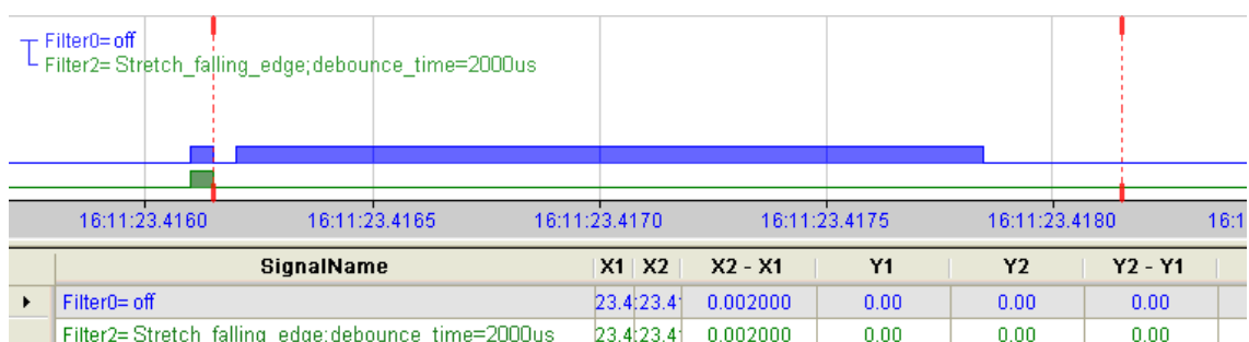
Рис. 4: Фильтр дребезга: "Растянуть задний фронт"
