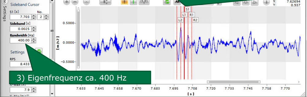
4) HK-FFT: Nach Anpassung Filtereinstellung (BP-Filter 750-4500Hz auf 150-750Hz) Innenringfrequenzen eindeutig sichtbar!
