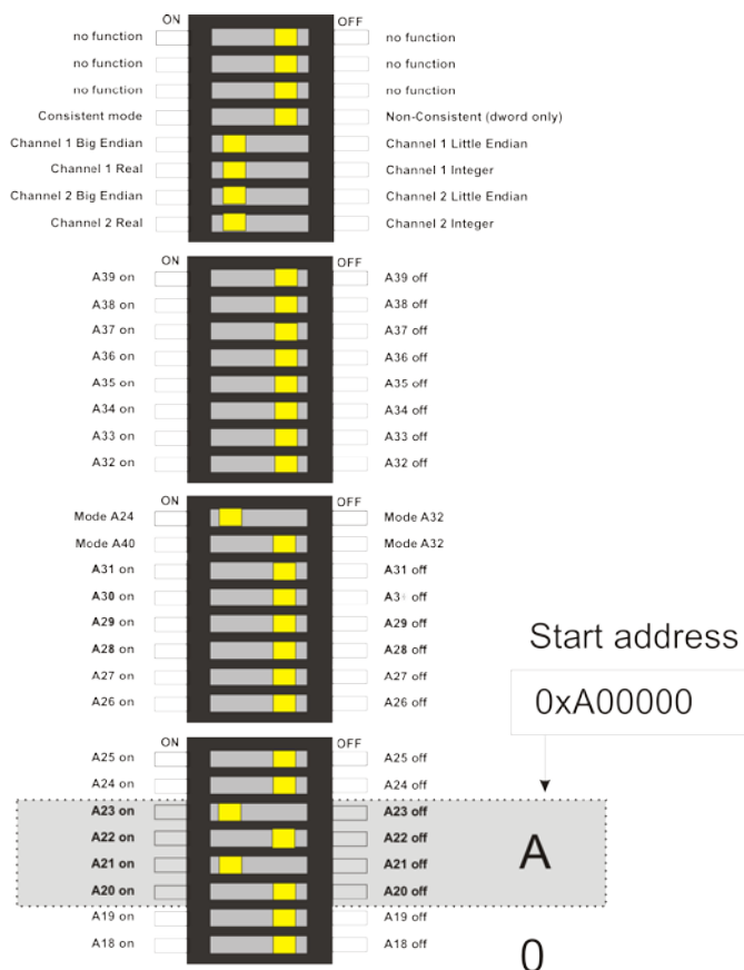
Рис. 9 DIP-переключатель, настройки для GE 90/70 (одна или первая карта ibaLink-VME)
