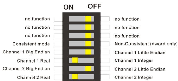
Рис. 10: DIP-переключатель, настройки для SIMATIC TDC (одна или первая карта ibaLink-VME)
