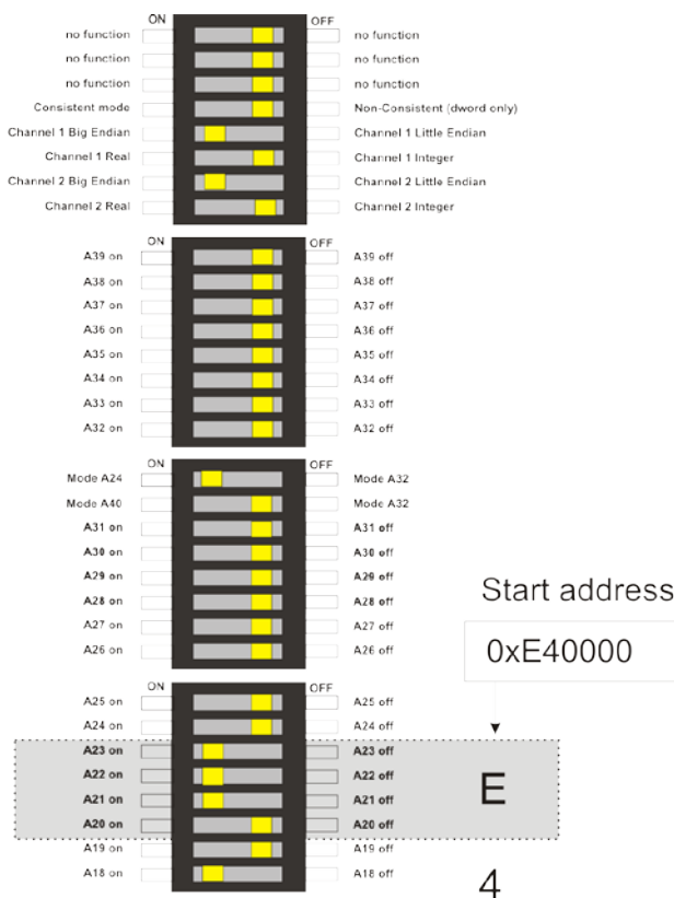
Рис. 4 DIP-переключатель, настройки для ALSPA CP80/A800 (одна или первая карта ibaLink-VME)
