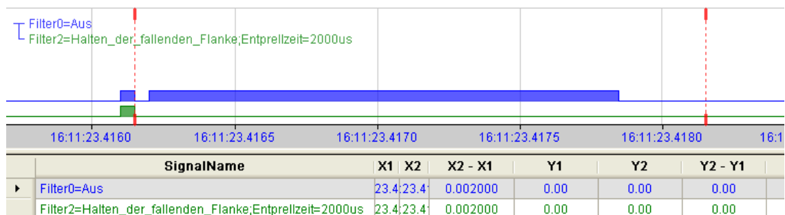
Abbildung 7: Entprellfilter: „Halten der fallenden Flanke“
